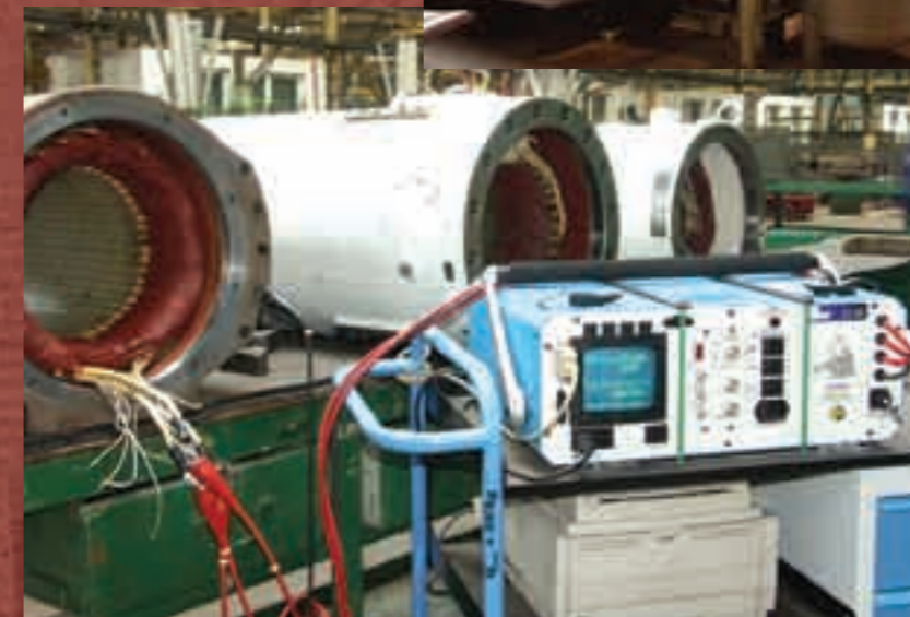
Kontrola jakości – diagnostyka uzwojeń.
